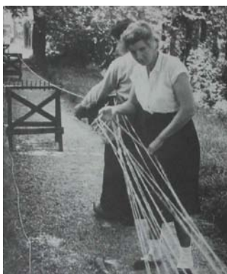
Touwslager Roest en zijn vrouw (Lekkerkerk) aan het werk met de haspel
