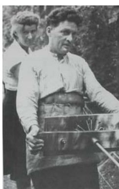
Touwslager Roest en zijn vrouw (Lekkerkerk) aan het werk met de haspel
