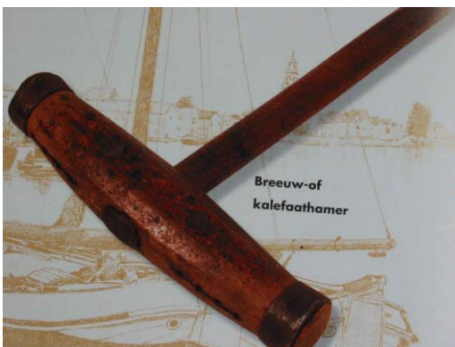
De huidgangen worden met uitgeplozen touw gebreeuwd
